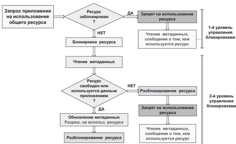
Рисунок 6 – Блок-схема выполнения запроса на использование общего ресурса
