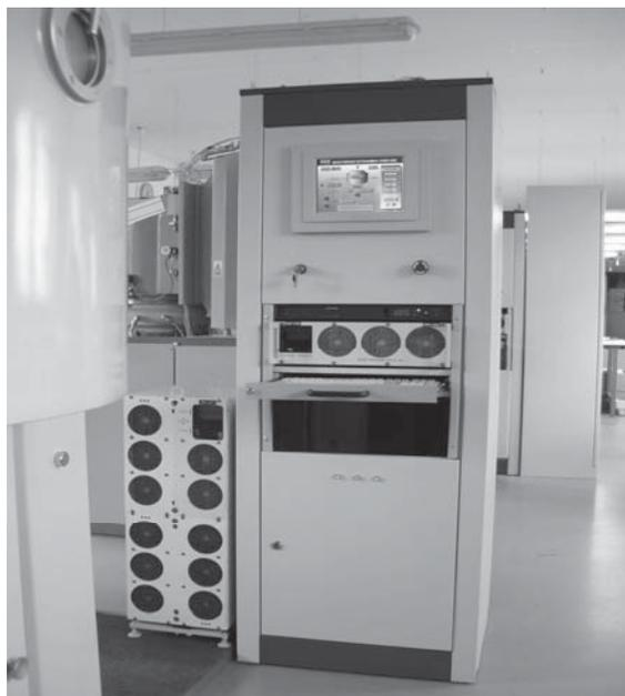
Рисунок 1 – Шкаф системы управления вакуумной установки УНИП-900
