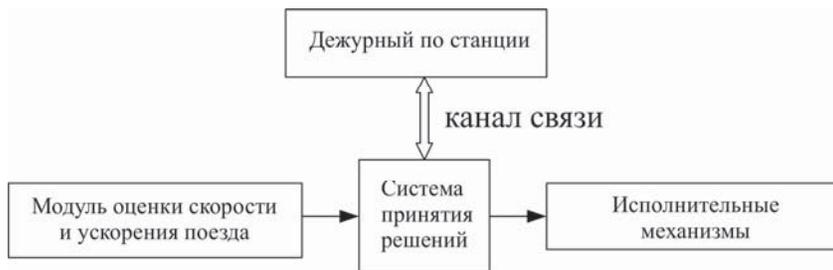
Рисунок 1 – Общая схема системы управления переездом
