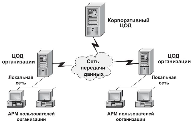
Рисунок 1 – Схема функционирования ЦОД
