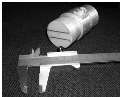
Рисунок 2 – Внешний вид датчика КОВТД-15-ВВ
