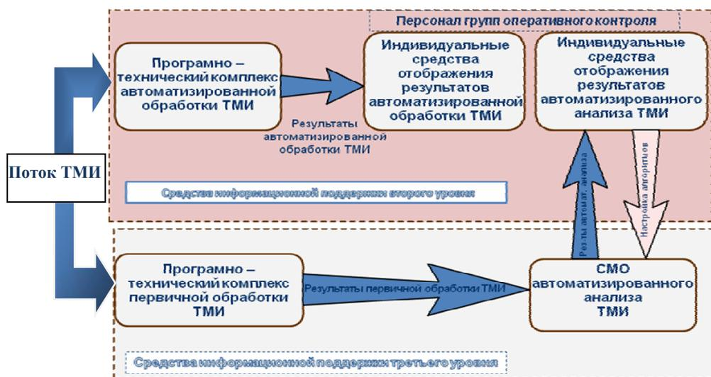
Рисунок 6 – Взаимодействие средств автоматизированной обработки и автоматизированного анализа ТМИ в контуре оперативного управления
