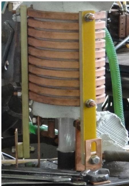
Рис.5 Макет индукционной системы
