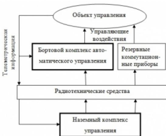
Рисунок 1 - Общая схема взаимосвязей НКУ и БКУ МКС как объекта управления.
