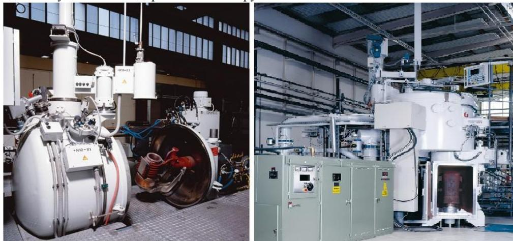
Рисунок 3 – Установки LEICOMELT® для вакуумной индукционной плавки
