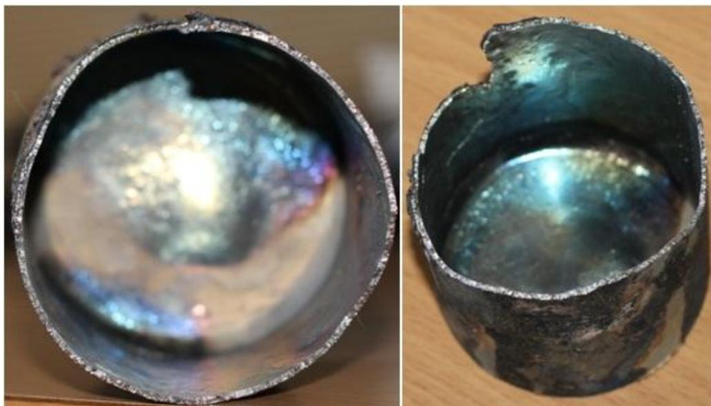
Рисунок 6 – Результат эксперимента. Остатки заготовки из ВТ6 диаметром 60 мм и высотой 100 мм. Стенка гарнисажа ~ 1,5 мм
