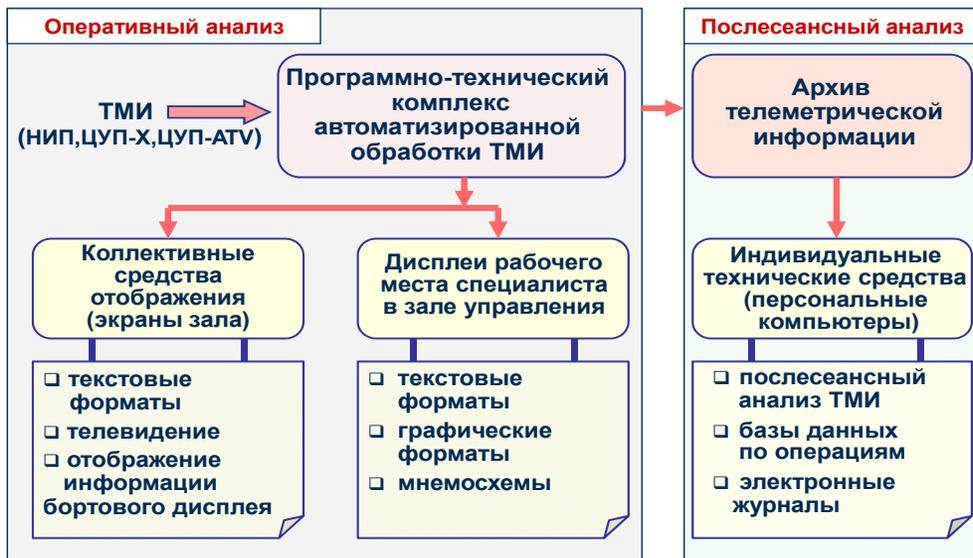
Рисунок 1- Укрупненный состав и возможности программно-технического комплекса автоматизированной обработки ТМИ.
