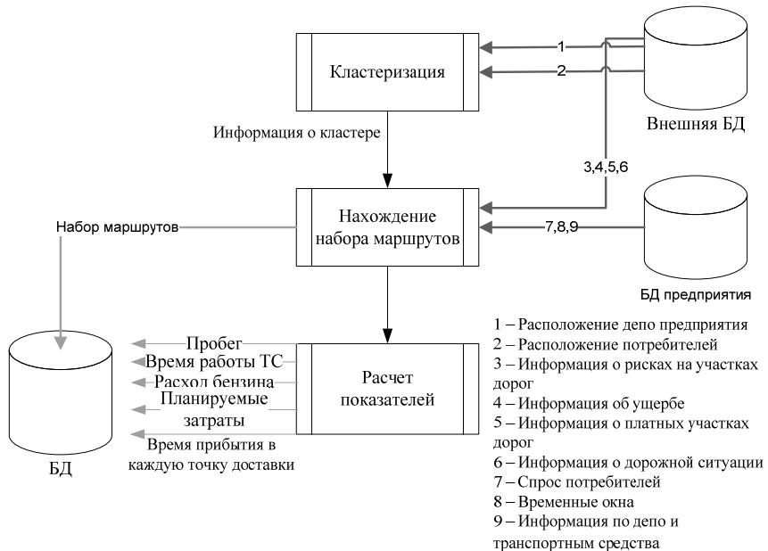
Рисунок 2 – Схема решения задачи формирования рациональных маршрутов в системе планирования транспортного режима при перевозках готовой продукции
