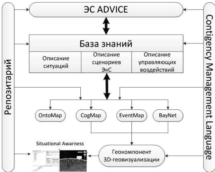
Рисунок 2 – Архитектура Ситуационного полигона
